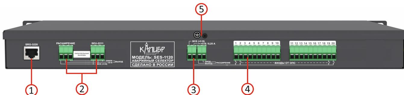
1. Разъем (информационный выход) для приема/передачи управляющего сигнала аварийной информации на Калибр SRG-3220;
